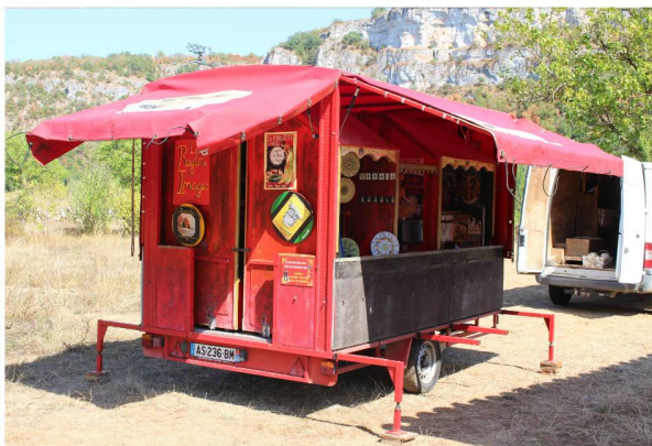
4 : Ouverture des auvents (verins à gaz)
