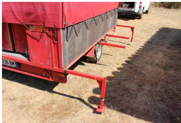
2 : mise en place des barres de support des ridelles par simple glissement dans les tubes carrés prévus sur la structure.
