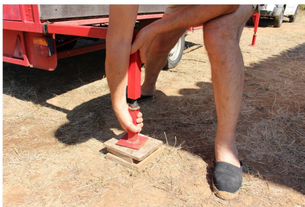
3 : Réglage de la hauteur des pieds d'angle, ce qui permet de s'adapter à tout terrain.
